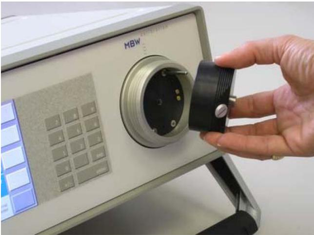
INS-973-SF6 은 SF6가스로 절연된 장비에 있어서 습도, 순도, 격실 압력 및 SO2농도를 측정하기 위한 최신의 분석기다. 내장 가스 저장용기/회수시스템을 갖추고 있는 INS-973-SF6는 한 대의 계기로 최상의 측정 솔루션을 제공한다.
